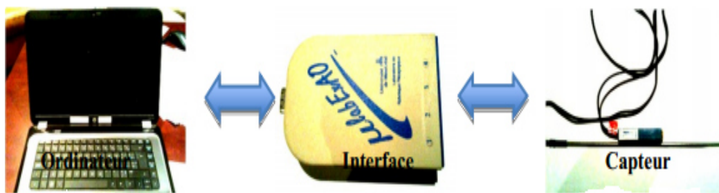
Figure 34: Montage de base pour l'EXAO avec connexion entre les composantes [1].
