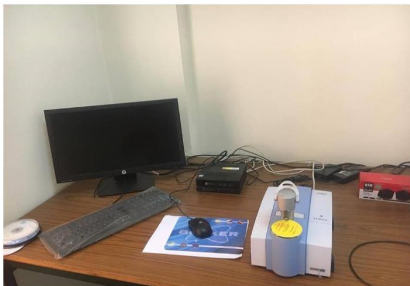
Figure 33. Spectromètre infrarouge à transformée de Fourier type Bruker Alpha Platinum-ATR.
