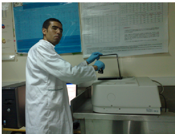
Figure 2-11 : Analyse d'enrichissement de deutérium par la spectroscopie infrarouge à transformée de Fourier.
