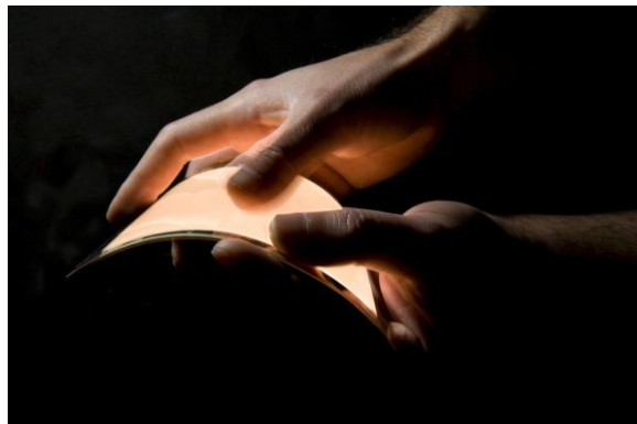
FIGURE 13: EXEMPLE D'UN PANNEAU D'ÉCLAIRAGE SOUPLE DE TECHNOLOGIE OLED (AGFA-GEVAERT).
