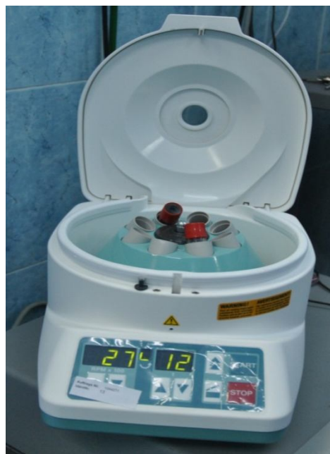
Figure 1 : Centrifugeuse PC02® de Process (A) ; les tubes ont été placés en nombre pair et de façon symétrique.
