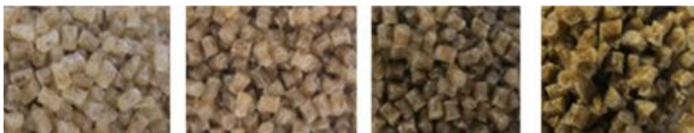
Figure I, 11: Granules de matériaux composites à divers pourcentage d'éléments de renforcement naturels
