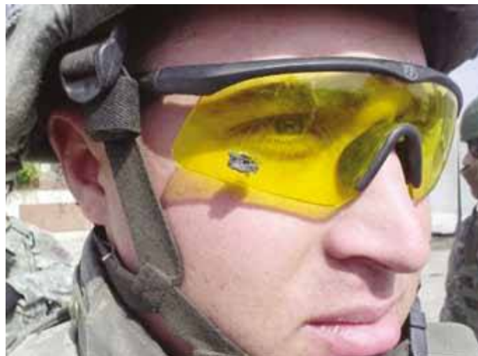
Figure 56 : soldat portant des lunettes de protection ayant arrêté un projectile provenant d'un engin explosif improvisé [252].
