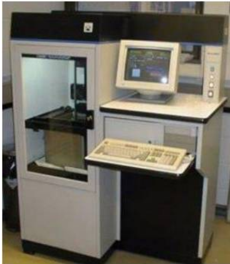
Figure 22: Imprimante SLA 250, première imprimante 3D commercialisée en 1988 [38]
