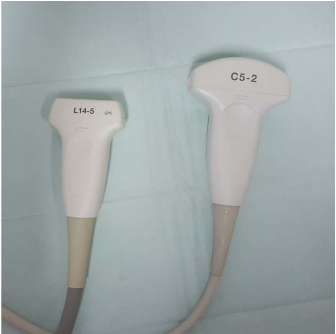
Figure 3: Sonde linéaire haute fréquence : sonde L 14-5 (sonde de gauche) Sonde convexe basse fréquence : sonde C 5-2 ( sonde de droite)
