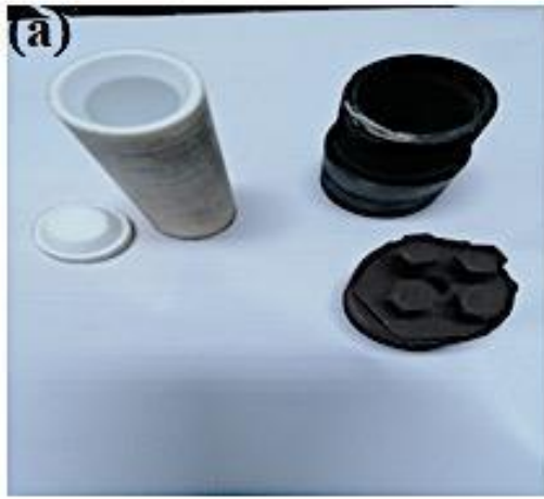
Figure I 2 a : Autoclave en Téflon utilisé dans la méthode Hydrothermal
