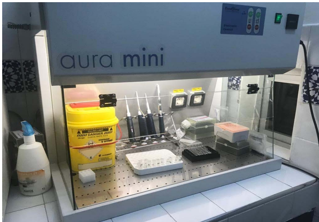
Figure 21 : Le poste de sécurité microbiologique PSM II (photo du service de Microbiologie de l'HMA)
