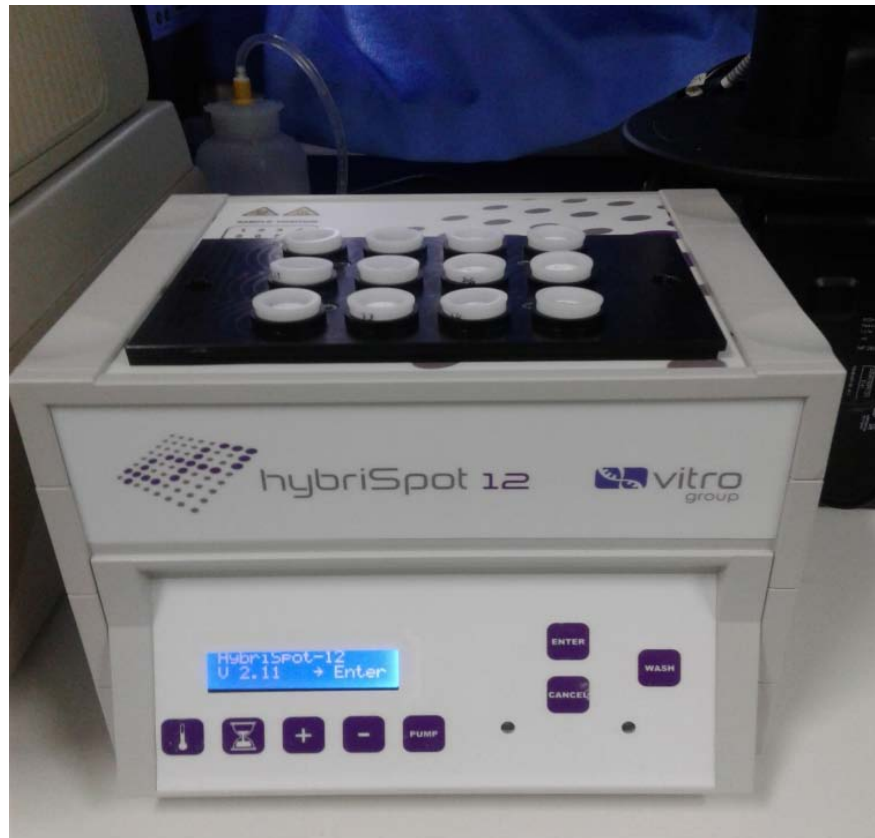
Figure 26: Pucés HPV placées dans l'Hybrispot 12 (photo du service de Microbiologie de l'HMA)
