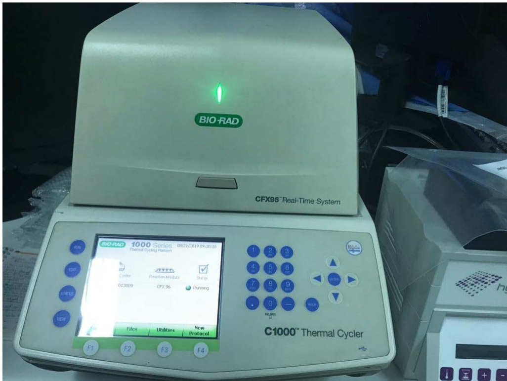
Figure 23 : Système de PCR en temps réel CFX 96 de BIORAD
