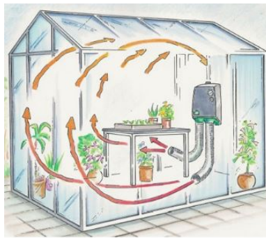
FIGURE 1.2 – Conduite automatique du microclimat interne d'une serre
