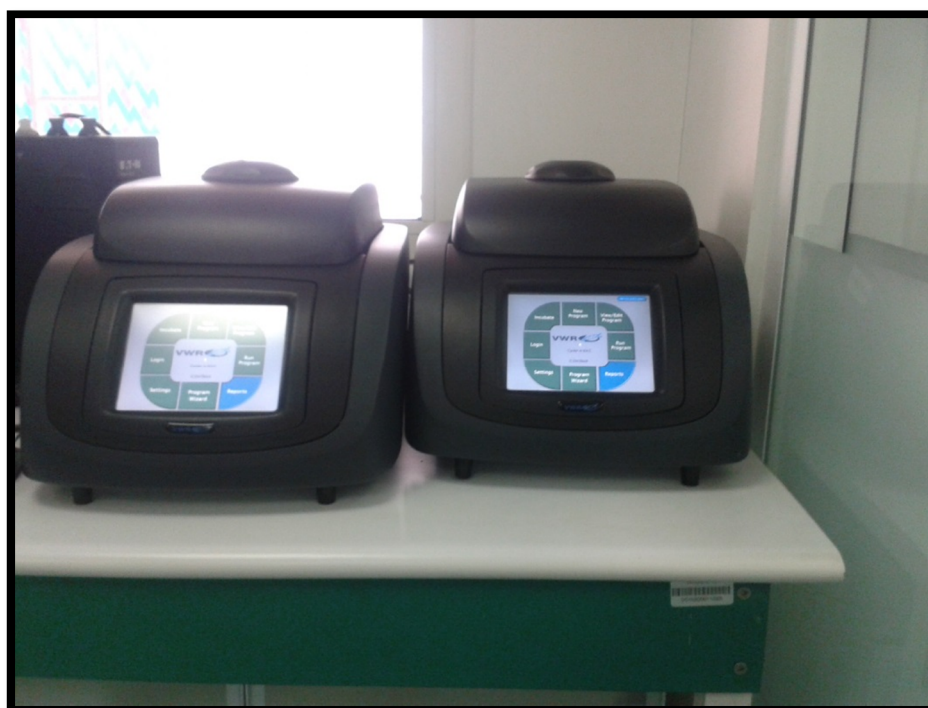
Figure 30 : Thermocycleurs du laboratoire recherche du CHIS
