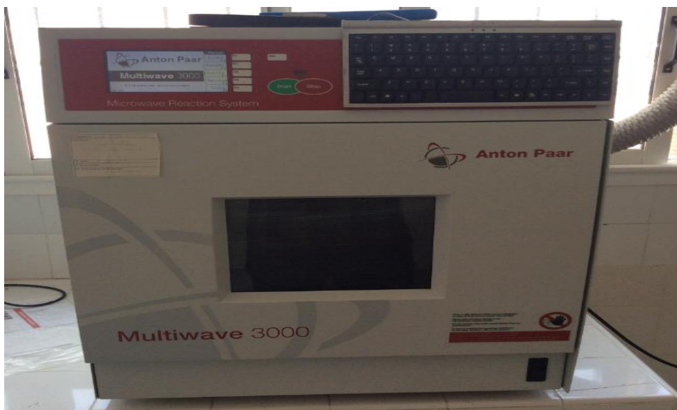
Photo 11 : Four à micro-ondes pour la digestion des échantillons.
