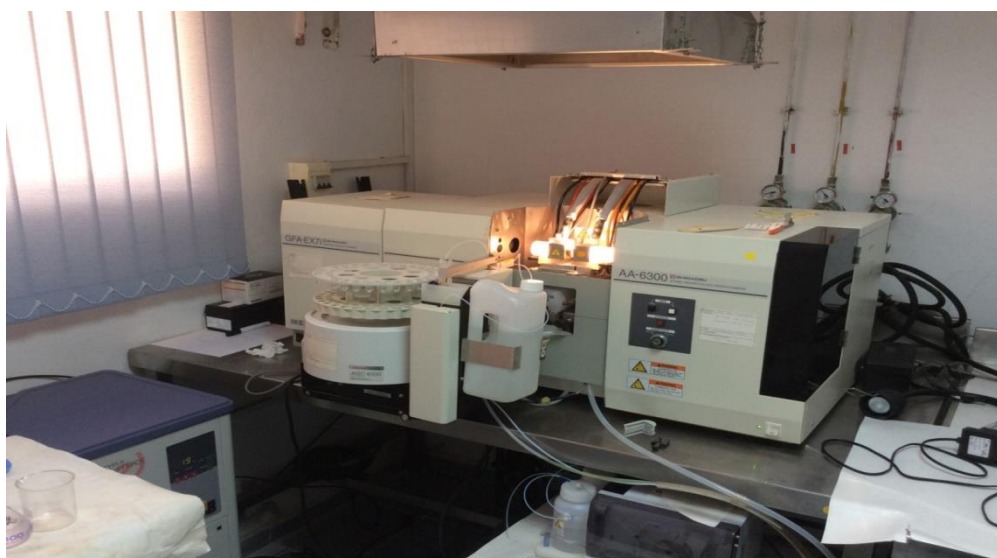
Photo 12 : Spectrophotomètre d'absorption atomique - Four à graphite.
