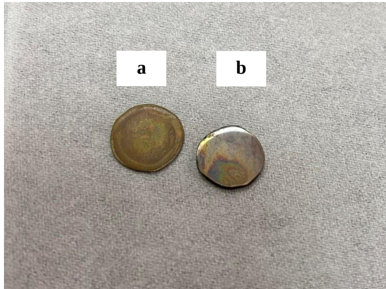
Figure 15. Sections circulaires des d'alliage (a) Cu-10Ni et (b) Cu-30Ni
