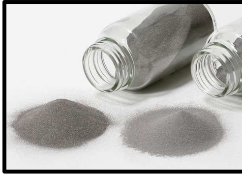
Figure 3 : Titane Ti6AL4V en poudre (source : primante3d)
