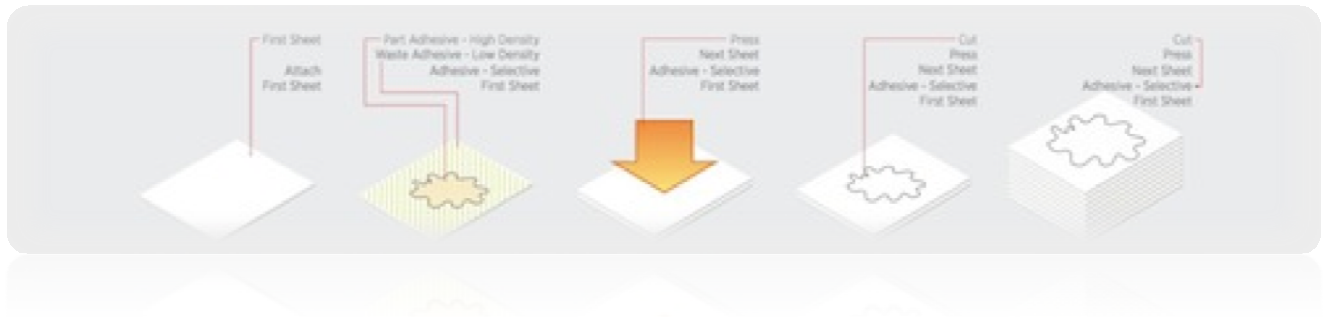
Figure 14 : Principe de l'encollage papier (Source : Mcor Technologie®)
