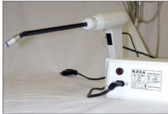
الصورة رقم 8 جهاز الأشعة تحت الحمراء (المولد والمسدس).
