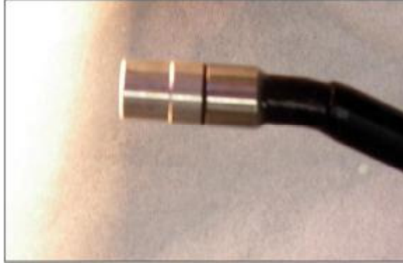
الصورة رقم 9:نهاية مسدس جهاز الأشعة تحت الحمراء مغطاة بغشاء تفلون.
