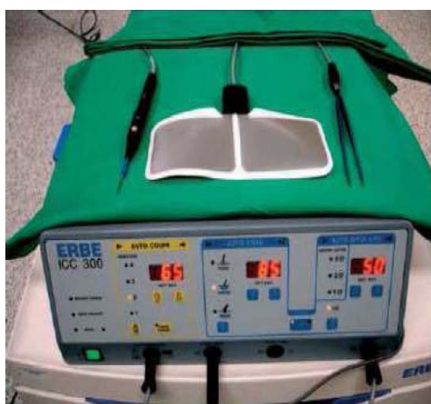
Fig. 37 : Bistouri électrique. Mode monopolaire et bipolaire. Plaque neutre double zone
