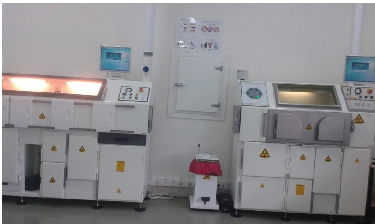
Figure 8 : Laboratoire chaud : équipé de 2 enceintes blindées (haute énergie et basse énergie)
