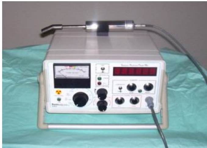
Figure 2 : Sonde de détection isotopique [17]
