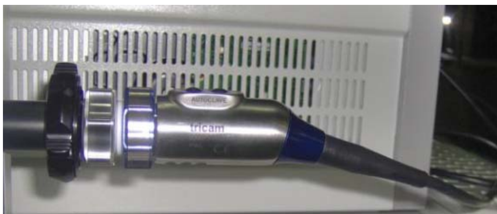
Figure 12 : la camera endoscopique reliant l'optique à la colonne vidéo
