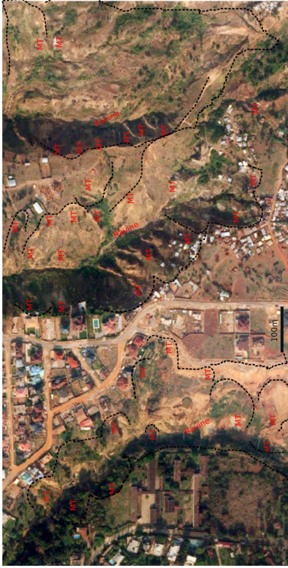
Figure III-13: Les mouvements de terrain des quartiers Vugizo Sororezo et Mugoboka. Les trois grands ravins sont visibles sur les photographies aériennes de 1958 avec une rupture de pente fraîche, ce qui justifie leur activité à ce moment. Sur les photographies aériennes anciennes, les alentours de ces ravins ne sont pas habités. Ce qui n'est pas le cas en 2012. Les ravins restent encore actifs avec des mouvements de terrain qui se déclenchent sur leur flancs.
