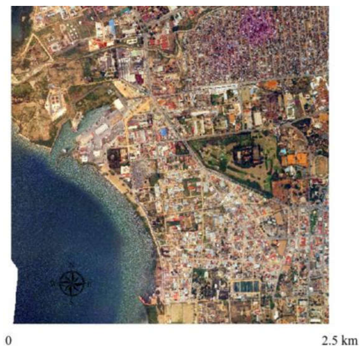
Figure III-4: Une des 4000 images utilisées pour la mosaïque de l'ortho-photo du Burundi. Chaque photographie aérienne a une taille de 2.5km*2.5km avec une résolution spatiale de 0.5m. Toutes les images ont été prises en juillet 2012. Ces images serviront à l'interprétation et la délimitation des cicatrices de MTs qui existaient à cette époque. Sur la base de ces photos aériennes, nous avons produit un MNE de 10m qui est utilisé pour les analyses topographiques.
