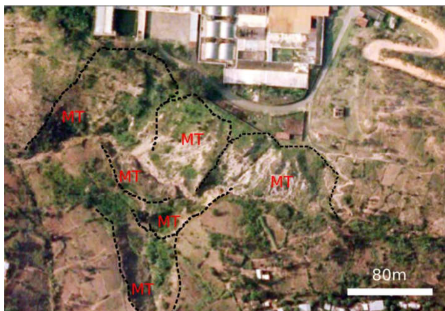
Figure III-18: Cartographie des mouvements de terrain à base des ortho-photos, MTs qui menacent une le campus Kiriri.
