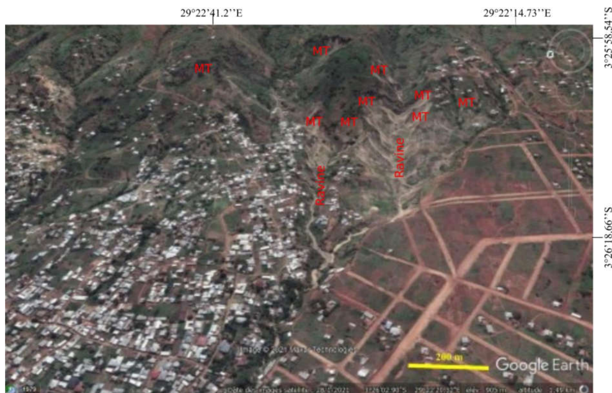
Figure III-9: Mouvements de terrain dans le quartier Kizingwe, impacts sur l'urbanisation. Les images de Google Earth montrent deux grandes ravines avec des processus de glissements associés qui menacent un quartier non viabilisé (Kamesa) et un autre en cours de viabilisation (Kizingwe) au sud de Bujumbura.
