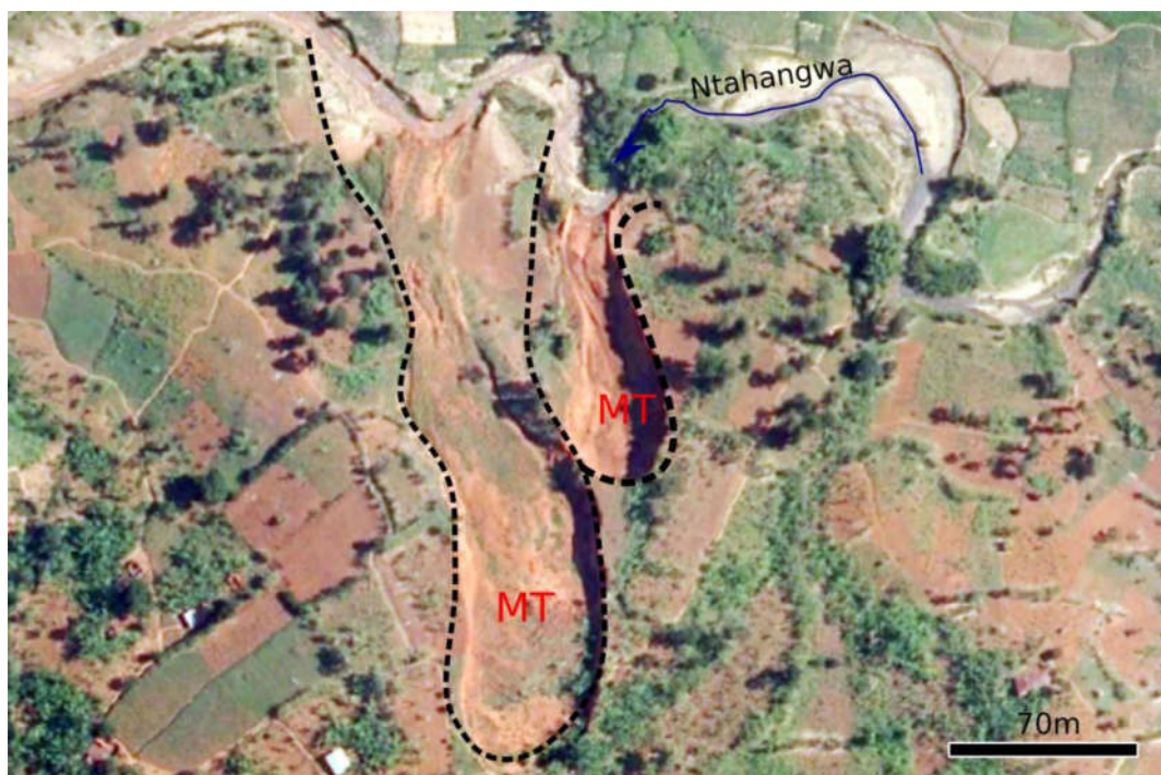
Figure III-20: Cartographie des mouvements de terrain à base des ortho-photos dans les champs agricoles, images très HR, Commune Isale. Un grand MT de type flowslide suivi d'une petite activation de la base s'observe vers l'est en amont du bassin versant de la rivière Ntakangwa. Les deux MTs se sont produits dans un sol latéritique très épais issu de l'altération des phyllites.
