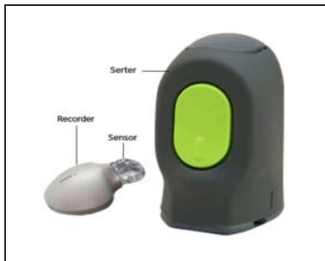
Figure n°42 : les 3 éléments d'un CGM
