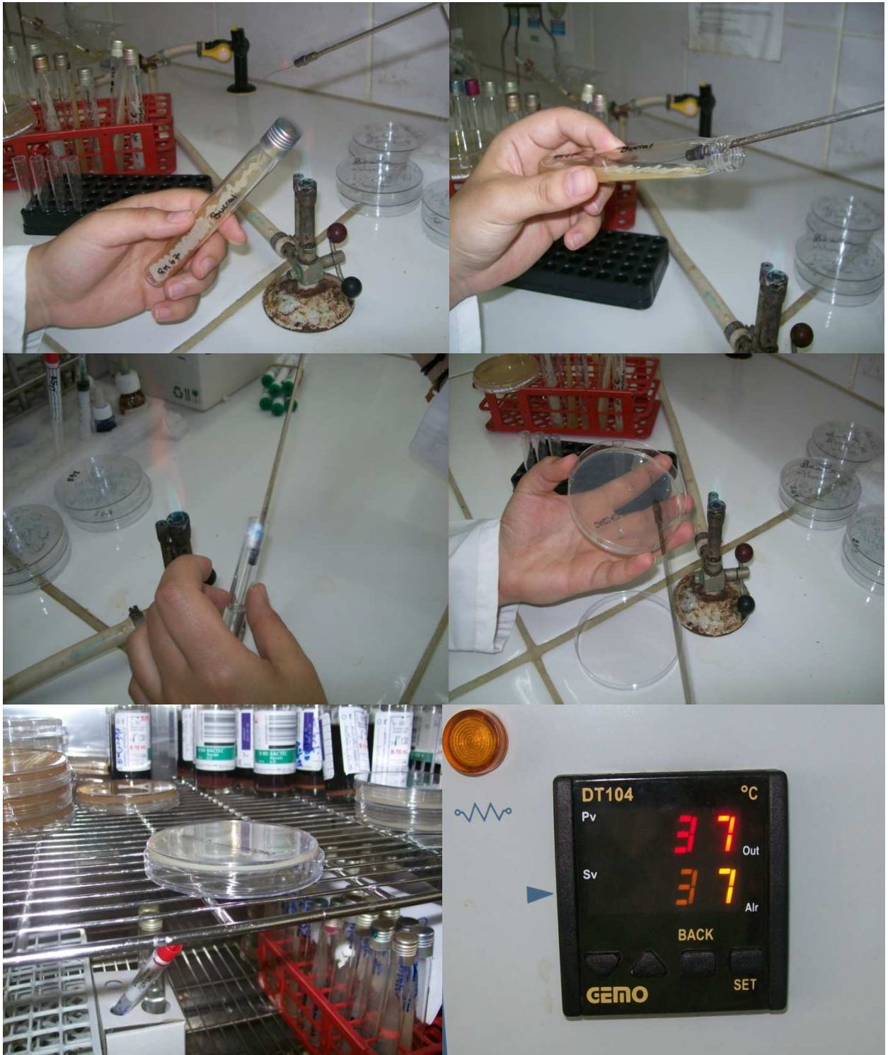
Figure 1 : Ensemencement et incubation des milieux de culture [Photos du laboratoire de parasitologie mycologie de l'HMIMV de Rabat
