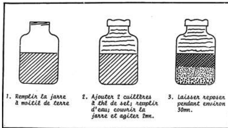
Figure 28. Essai de sédimentation.
