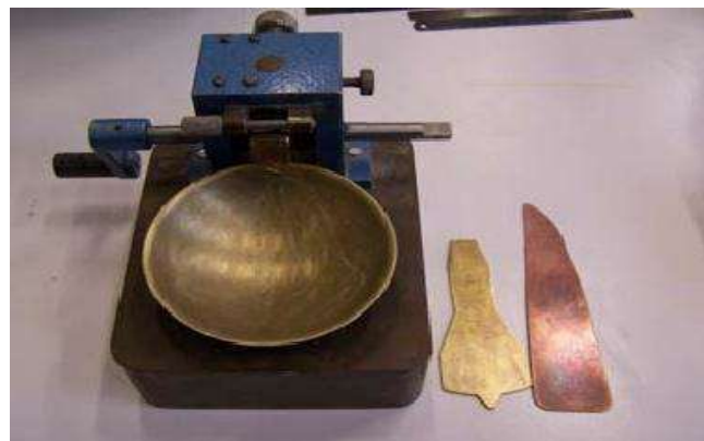
Figure 31. Appareil de Casagrande.
