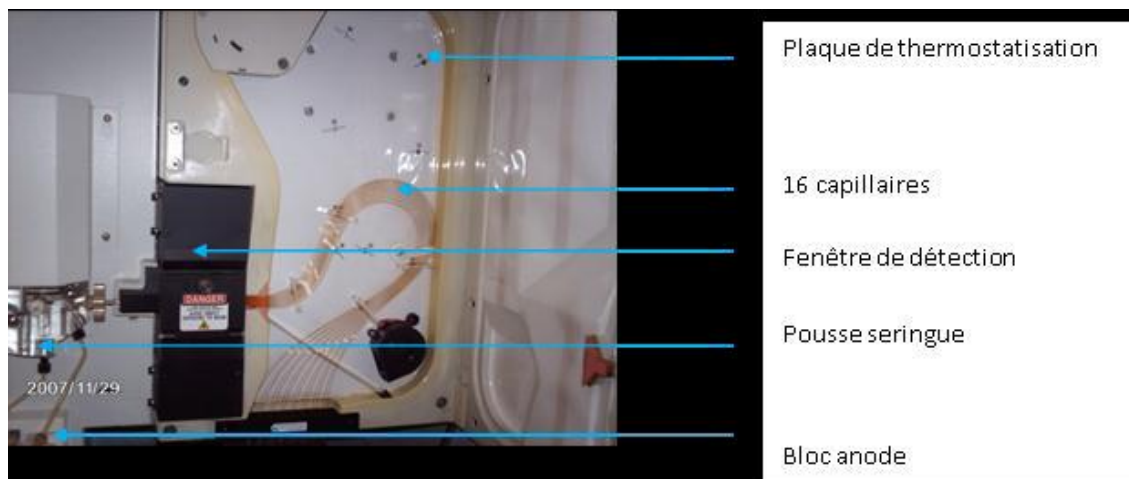
Photo4 : Appareil de séquençage 16 capillaires : ABI 3130xl d'Applied Biosystems
