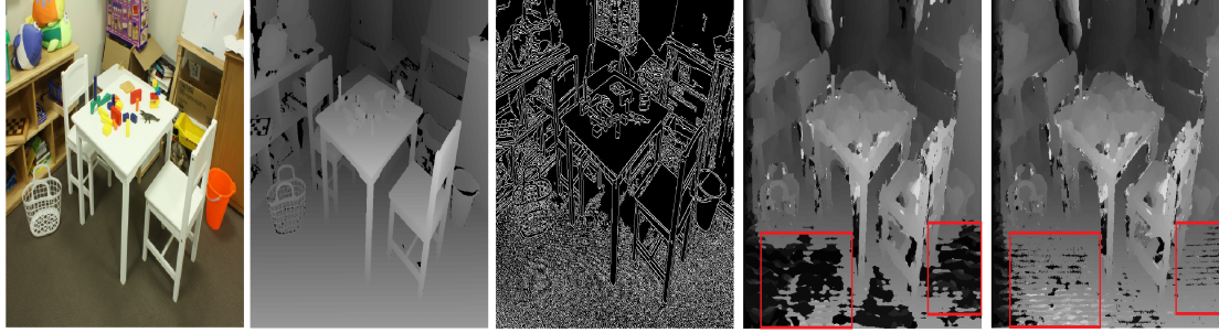
FIGURE 2.3 – De gauche à droite : image de gauche, carte de disparité de la vérité du terrain, image de contour, carte de disparité calculée en fonction de la région adaptative croisée, et carte de disparité obtenue par la méthode modifiée.
