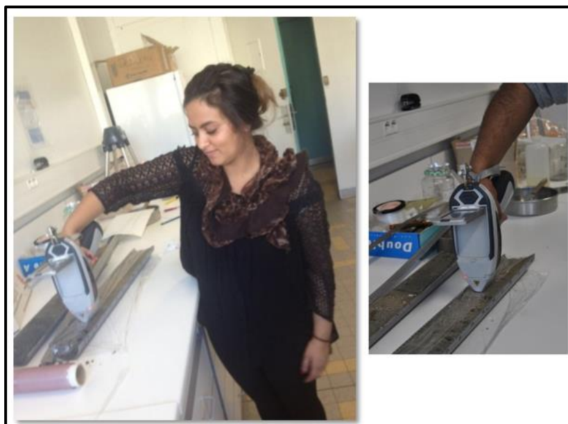
Figure 30 : Photographie de l'analyse de la carotte bR2 par le spectromètre des Rayons X (XRF-moblie) (X- florescence mobile) de type Nitron, au laboratoire des Géosciences de l'université de Montpellier (France).
