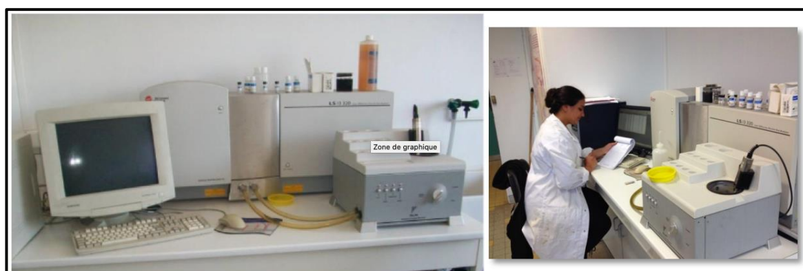
Figure 29 : Photographie du granulomètre laser du laboratoire des Géosciences de l'université de Montpellier (France).
