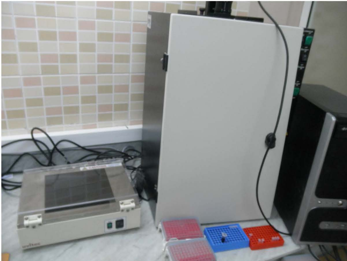
Figure 18 : dispositif de migration des produits de PCR et photographie des bandes par le transilluminateur à rayons ultra-violet à l'unité de génétique
