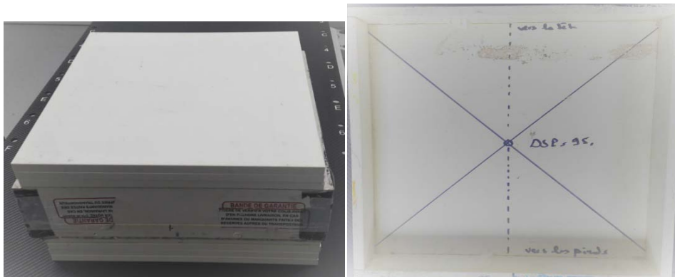
Figure 2 : Photo de la boîte en PMMA utilisée pour l'irradiation des PSL au service de radiothérapie.
