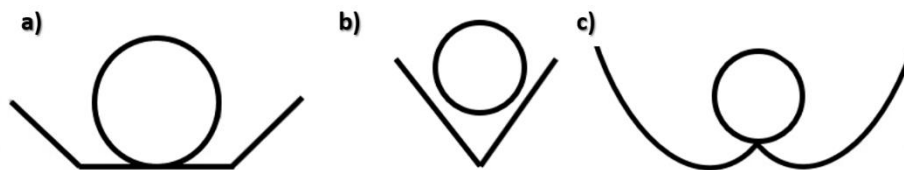
Figure 17: Types de collections d'irradiation solaire utilisés dans le réacteur photo catalytique solaire : a) auge en V, b) rainure en V et c) composé parabolique.
