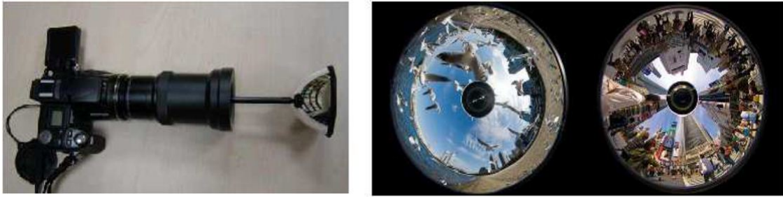
FIGURE 1.8 – Caméra à miroir convexe
