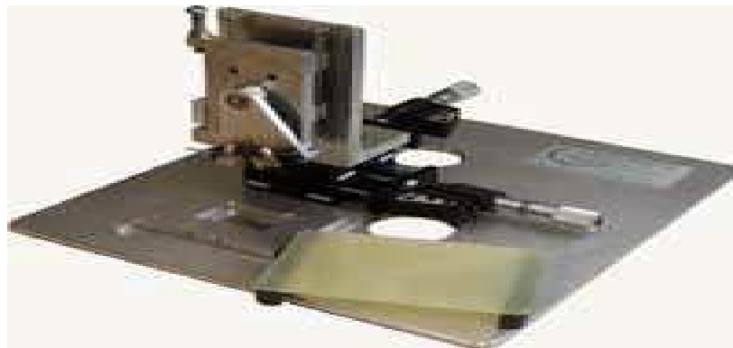
Figure 10 : Le TMA Micro Arrayer : instrument pour réaliser des blocs TMA [33]
