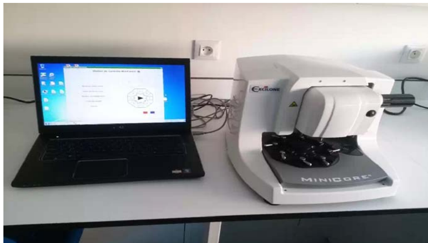
Figure 11 : Construction d'un bloc TMA. Les carottes sont prélevées à l'aide de l'aiguille du microArrayer, à partir des blocs de biopsies donneurs. Ensuite ces carottes sont transférées vers le bloc de TMA receveur [Laboratoire d'immunohistochimie du Centre de Recherche Clinique au sein du CHU Mohammed VI de Marrakech].
