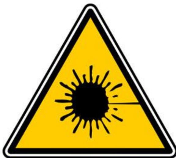
Figure 38 : Pictogramme d'avertissement à utiliser pour signaler un danger dû au rayonnement laser [19]
