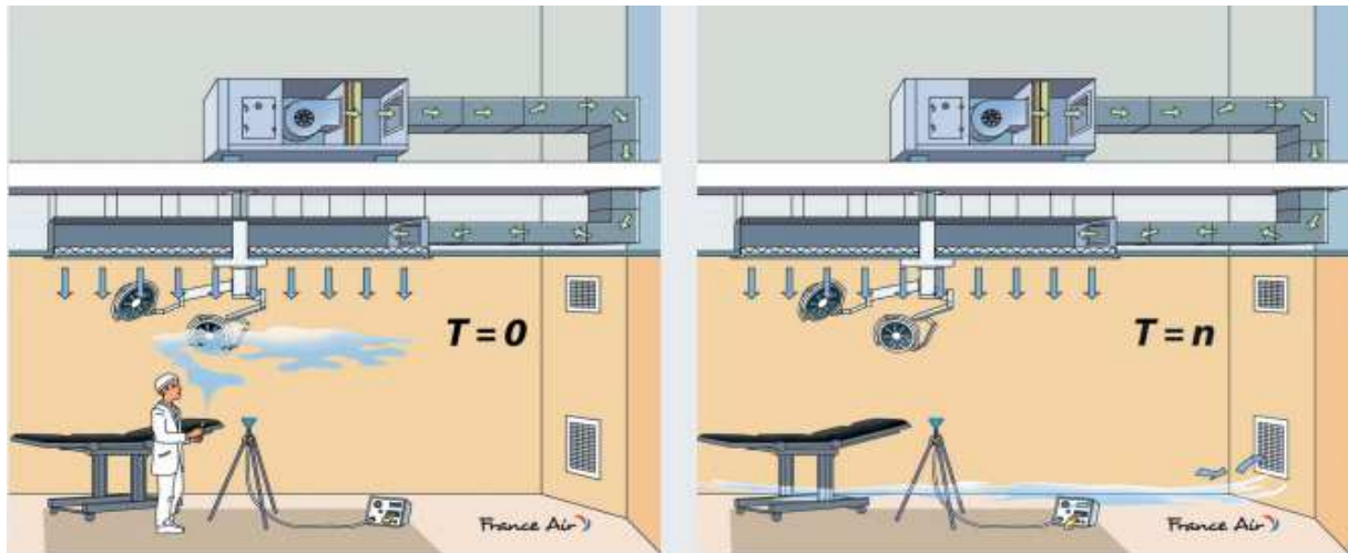
Figure 25 : Installation de traitement de l'air pour le contrôle particulaire [79].
