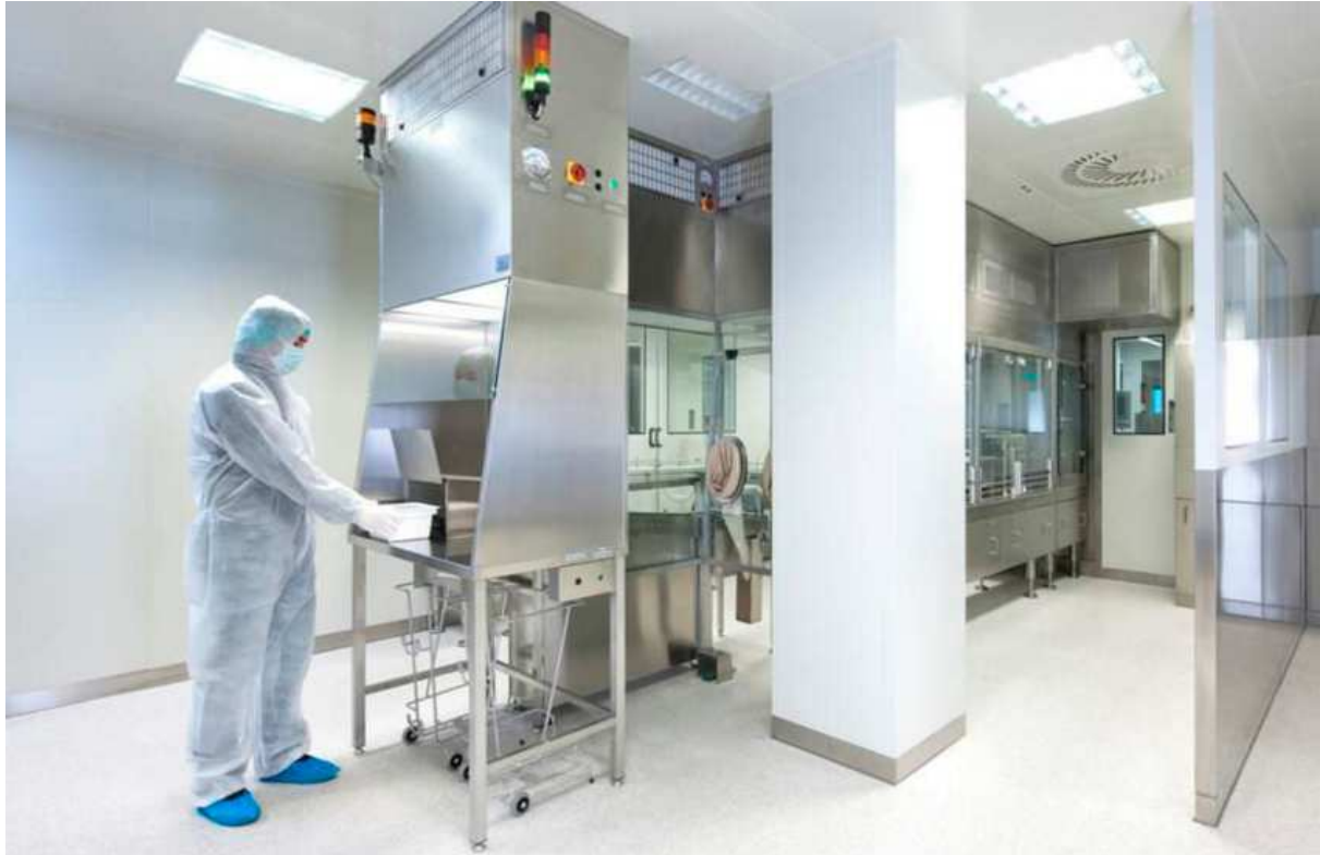
Figure 9 : Système de barrière à accès restreint (RABS) [39]
