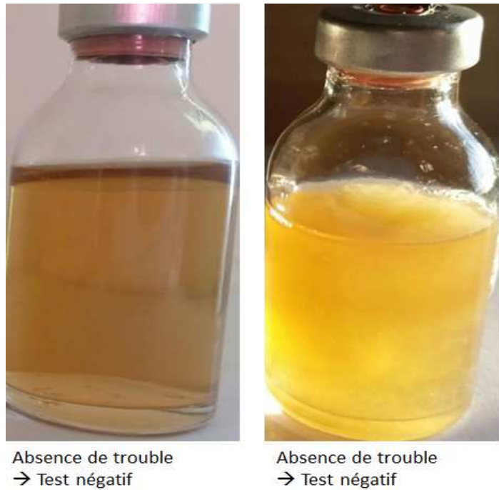
Figure 45 : Illustration d'un flacon contaminé à droite et d'un flacon conforme à gauche, du test de remplissage aseptique.
