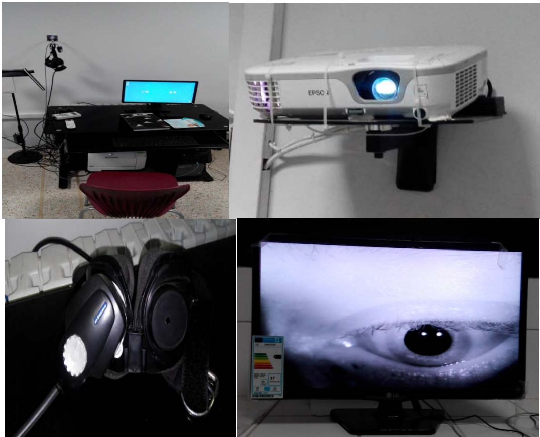
Figure 24 : Matériel de la videonystagmographie (VNG) ordinateur et logiciel d'application ; avec caméra infrarouge monoculaire sur le casque et vidéoprojecteur ; on voit la projection sur l'écran de l'image de l'œil capté par camera infrarouge. (Exploration fonctionnelle ; service d'ORL et CCF ; CHU Mohammed VI)
