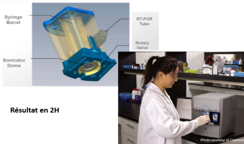
Figure 59: Insertion de la cartouche GeneXpert dans la machine (105)
