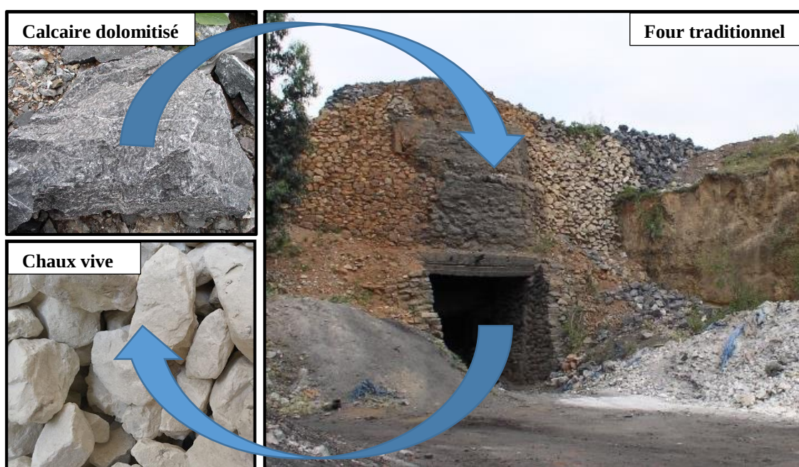
Figure 18. Calcaire dolomitisé et four traditionnel pour la production de chaux vive.
