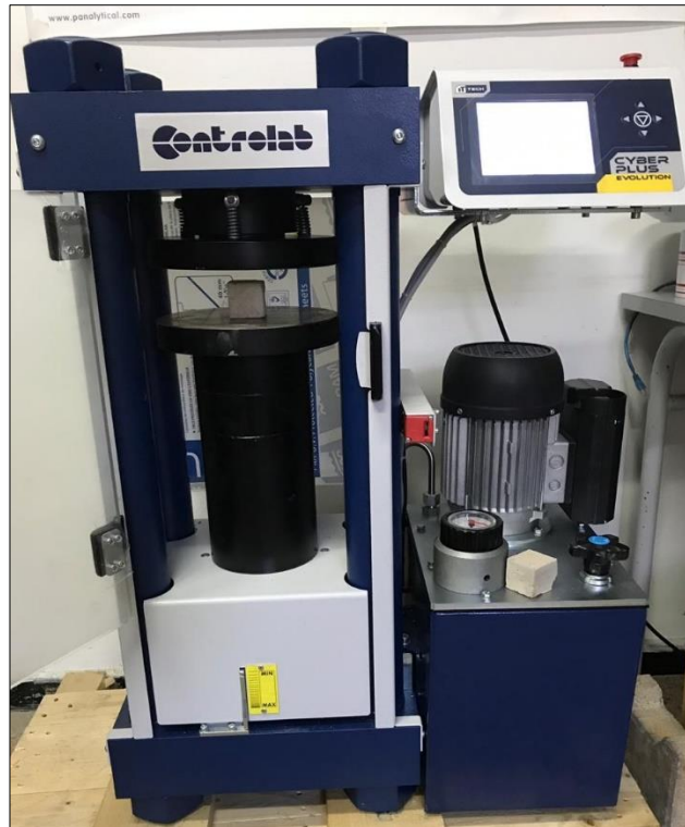
Figure 20. Presse hydraulique pour la détermination de la Rc des géopolymères synthétisés (Labo GeoM&E de l'IS-R).
