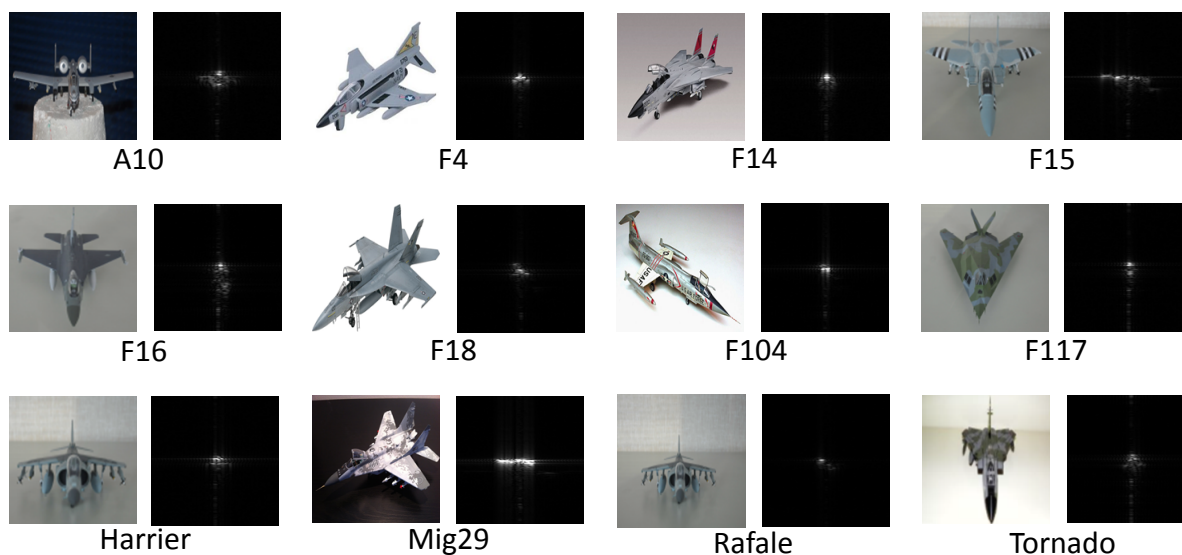
FIGURE 2.8 – Exemple des images ISAR acquises dans la chambre anéchoïque de l'ENSTA Bretagne ainsi que leurs maquettes (vérités terrains) correspondantes [Toumi, 2007, Toumi et al. , 2012].
