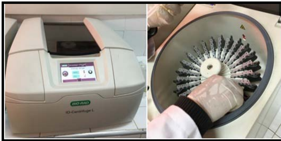
Figure18: Centrifugeuse de cartes gel ( fermée et ouverte avec placement des carte gels)
