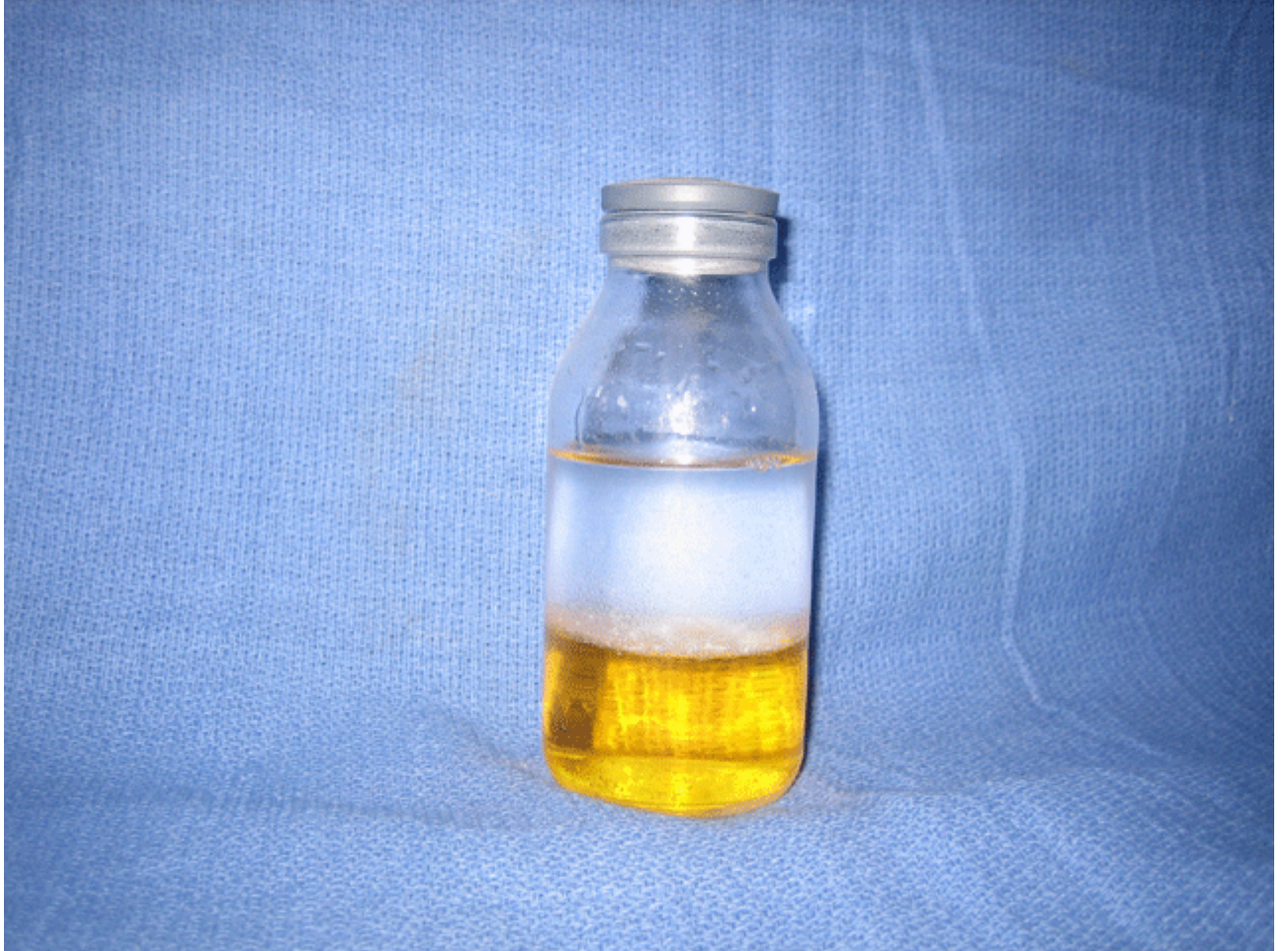
Fig.1 : Solvant récupéré après dégraissage par la méthode classique
