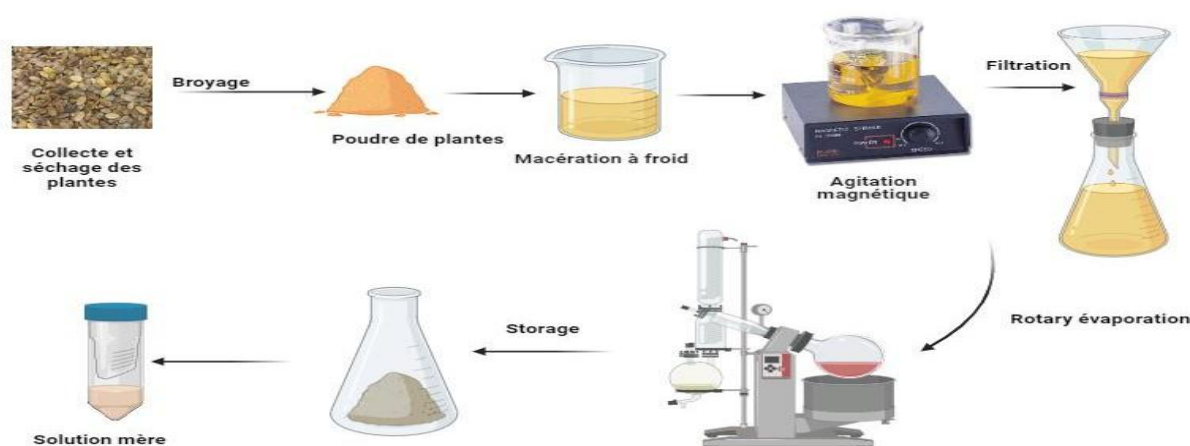
Figure 12 : Protocole expérimental de la préparation de l'extrait alcoolique par macération à froid.
