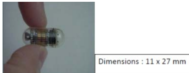
Figure 20 : Vidéocapsule avec ses dimensions
