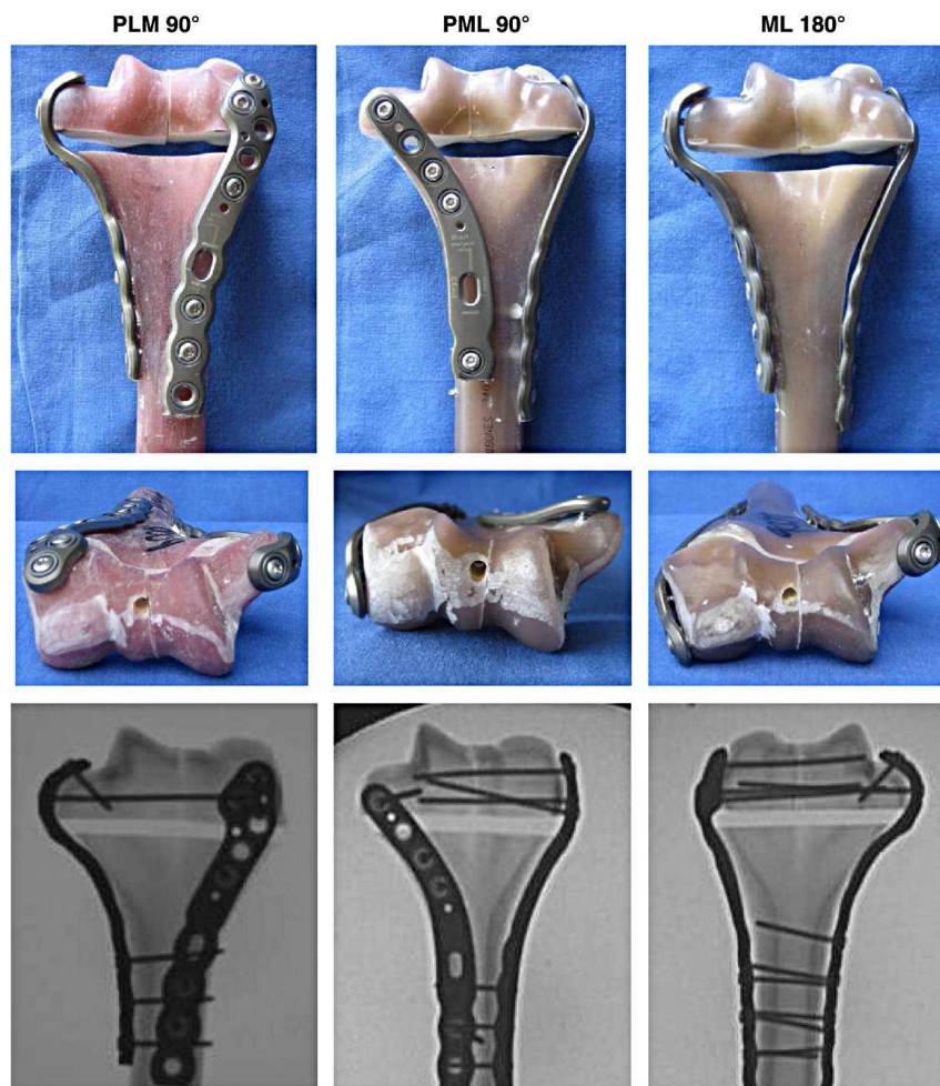
Fig.15 : Différentes configurations d'ostéosynthèses. Les deux premières colonnes présentent un montage perpendiculaire, la dernière colonne un montage parallèle
