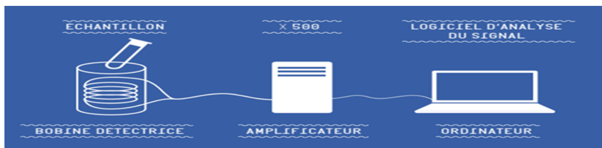
Fig. 9 : Le dispositif de détection des signaux électromagnétiques émis par l'ADN bactérien :
