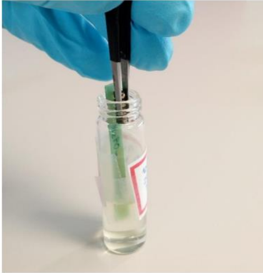
Figure 26: Dip coating (revêtement par immersion)
