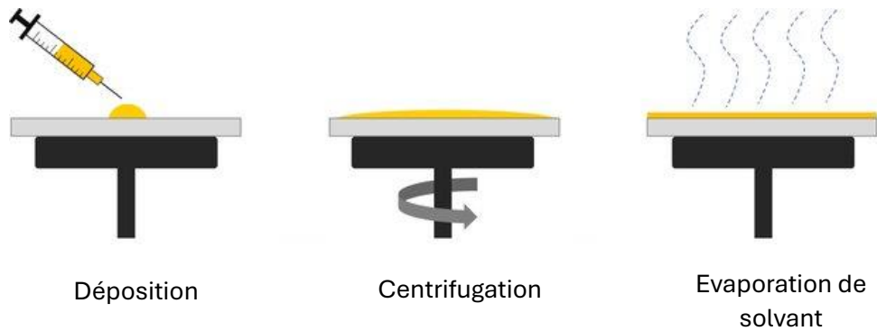
Figure 18: Spin coating (revêtement par centrifugation)
