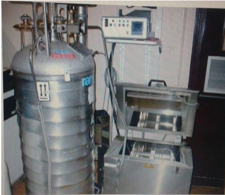
Figure 14 : appareil pour la congélation du sang [45]
