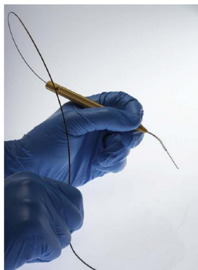
Figure 29 : La fibre et la pièce à main du laser CO2
