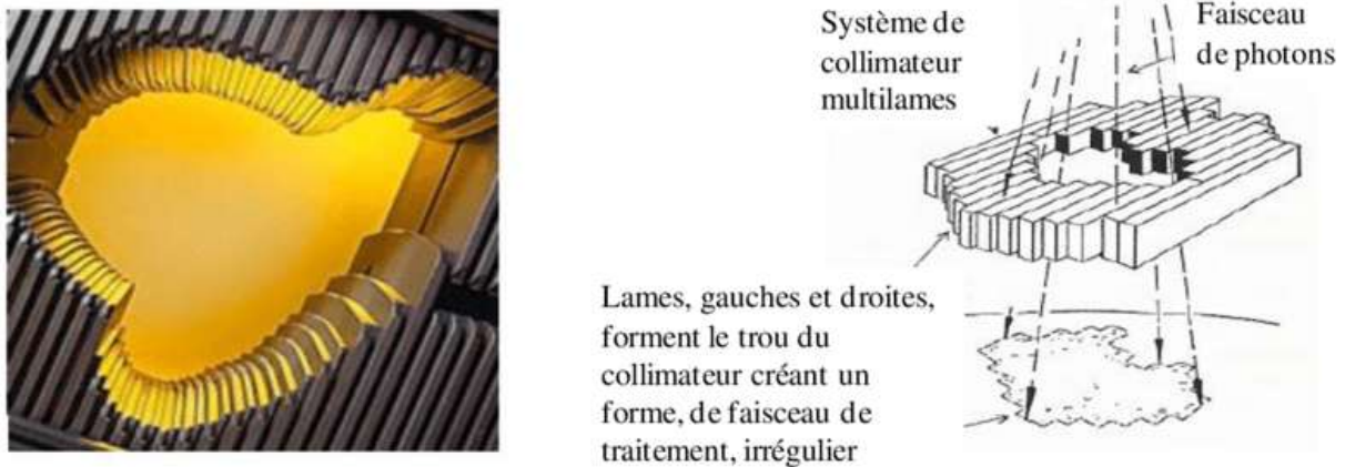
Figure 1.9 : Collimateur multi-lame du Varian CLinac IX
