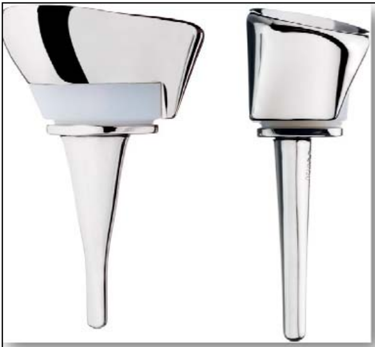
Figure 36 : La prothèse de remplacement et resurfaçage du radius distal est latéralisée (droite, gauche), existe en quatre tailles, la hauteur du bloc métaphyso-épiphysaire est modulable. Elle est fabriquée par le laboratoire DediennSanté(61).
